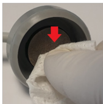
Figure 7 : Nettoyer la surface de contact (élec- trode)
