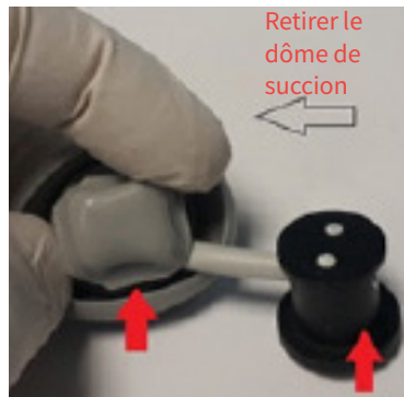
Figure 9 : Ôter le dôme de succion
