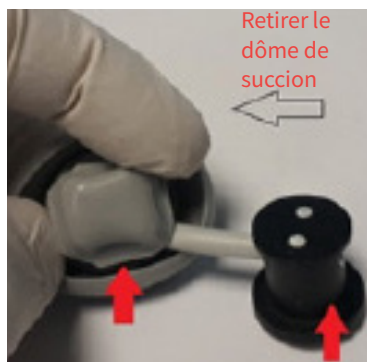
Figure 11 : Ôter le dôme de succion
