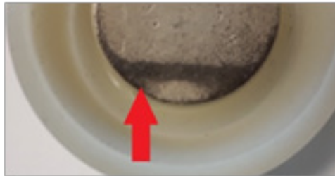
Figure 14 : Image d'erreur – décoloration de l'électrode
