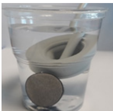
Figure 12 : Désinfection par immersion
