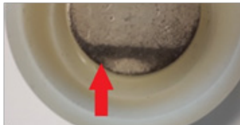
Abbildung 14: Fehlerbild - Verfärbung der Elektrode
