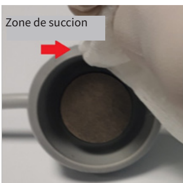
Figure 6 : Nettoyage du dôme de succion extérieur
