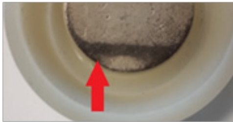
Abbildung 14: Fehlerbild - Verfärbung der Elektrode
