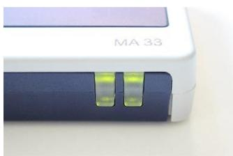
Les indicateurs lumineux verts sur le côté avant de l'appareil s'allument dès que l'appareil est connecté correctement à un PC (Figure 2).
